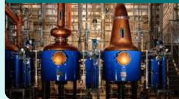
Distilleria a basse emissioni, che utilizza MVR (compressione meccanica dei vapori) per una produzione completamente sostenibile
